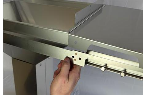
Wiederholen Sie den Vorgang für die hintere Traverse. Ziehen Sie anschließend alle Schrauben fest, um eine sichere Verbindung zu gewährleisten.
