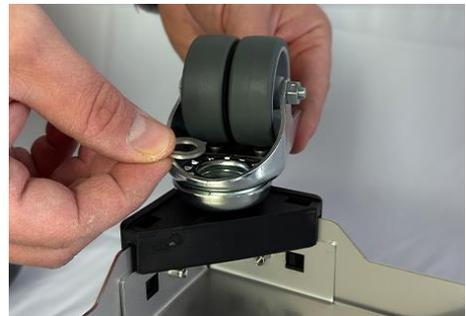
Führen Sie die Schraube durch das Loch der Rolle.
