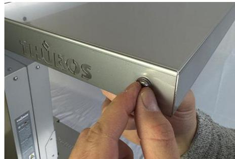
Setzen Sie die Schwenkhaube auf und richten Sie die Löcher der Haube mit den Löchern des Montageblechs aus.
